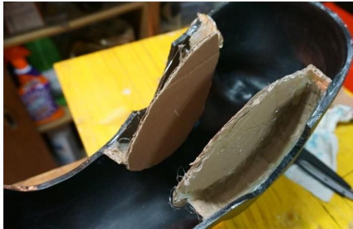
*Abbildung 26: Die Vorderseite des Kopfes mit der Führung aus Karton.*
