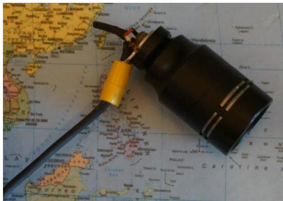
*Abbildung 17: Die Mikrofonkapsel mit bereits angelöteter Verlängerung.*
