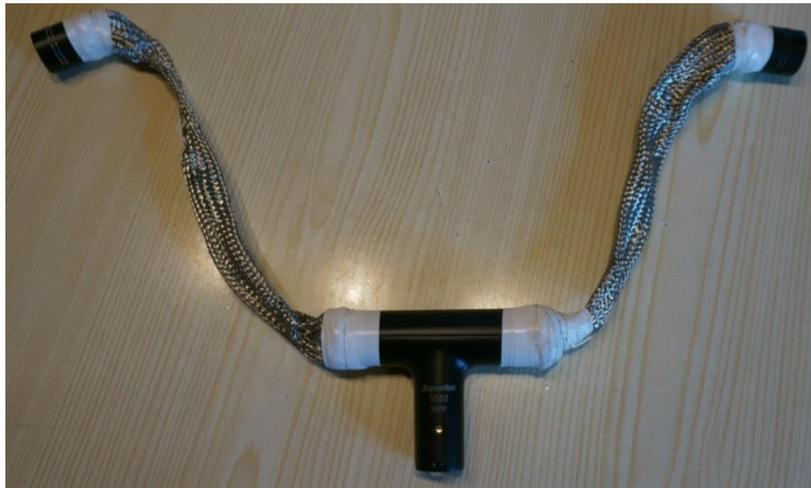
*Abbildung 18: Das Mikrofon mit dem Kupfer-Abschirmschlauch.*
