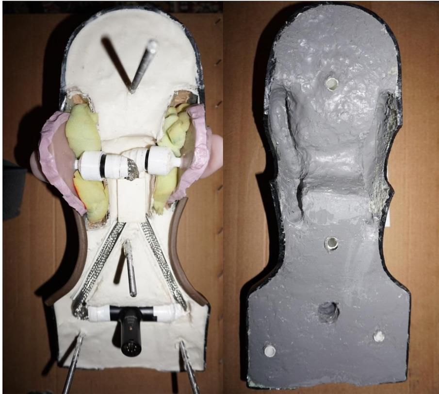
*Abbildung 27: links: Die Vorderseite mit Blick auf die in Montagekleber eingebetteten Kabelkanäle
