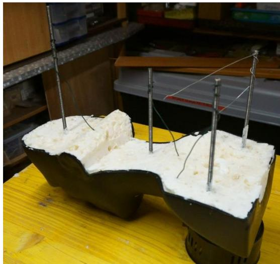
*Abbildung 25: Die gefüllte Vorderseite des Kopfes inklusive Gewindestangen.*
