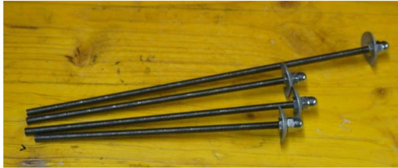
*Abbildung 24: Die Gewindestangen mit Blick auf die Zugentlastung.*
