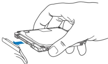
Der Stecker befindet sich an einem Kabel und verbleibt im Festplattenfach.
