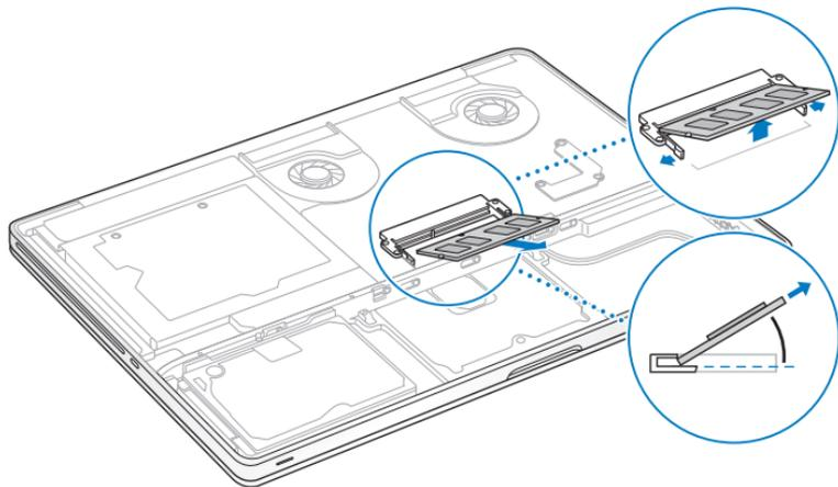
5 Fassen Sie das Speichermodul an den Rändern und ziehen Sie es aus dem Steckplatz heraus.
