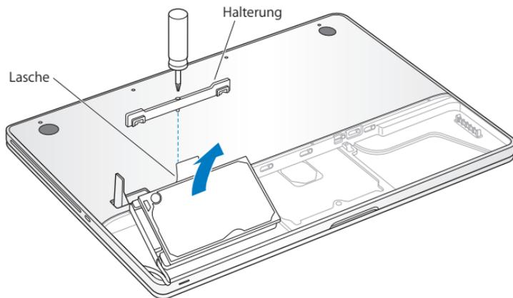
Die Halterung löst sich vom Laufwerk. Legen Sie sie so beiseite, dass sie nicht verloren gehen kann.
