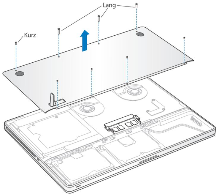
**Wichtig:** Durch das Entfernen des Gehäusebodens werden empfindliche interne Komponenten zugänglich. Achten Sie darauf, keine anderen Komponenten als die Speichereinheit zu berühren, wenn Sie Speichermodule entfernen oder hinzufügen.
