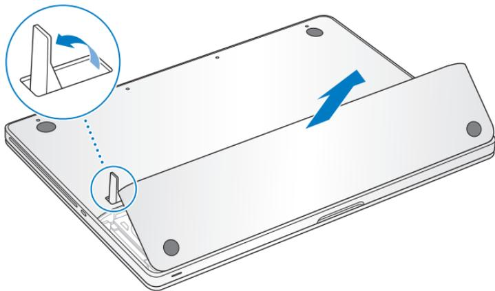
**Hinweis:** Die Verriegelung muss gelöst und geöffnet sein, damit die Batterie und die Abdeckung entfernt und ausgetauscht werden können.
