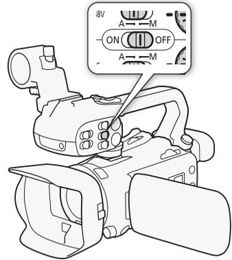
Stellen Sie den ON/OFF-Schalter des INPUT-Anschlusses auf OFF.
