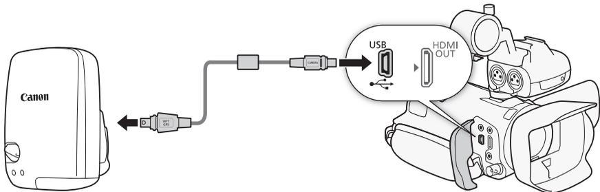
Wenn Sie den GPS-Empfänger GP-E2 an den Camcorder anschließen, verwenden Sie dazu das mit dem Empfänger mitgelieferte Anschlusskabel. Nachdem Sie den Empfänger angeschlossen haben, empfehlen wir, ihn am Griffriemen oder an der mit dem Empfänger mitgelieferten Tragetasche zu befestigen.
