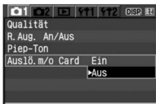
Wählen Sie auf der Registerkarte [01] die Option **[Auslö. m/o Card]** aus, und drücken Sie die Taste <SET>. Wählen Sie die Einstellung **[Aus]**, und drücken Sie die Taste <SET>.
