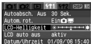
Wählen Sie auf der Registerkarte [F1] die Option [LCD-Helligkeit] aus, und drücken Sie die Taste <SET>. Passen Sie die Helligkeit auf dem Einstellungsbildschirm mit den Tasten <◀> an, und drücken Sie die Taste <SET>.
