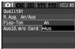
Wählen Sie auf der Registerkarte [01] die Option **[Piep-Ton]** aus, und drücken Sie die Taste <SET>. Wählen Sie die Einstellung **[Aus]**, und drücken Sie die Taste <SET>.
