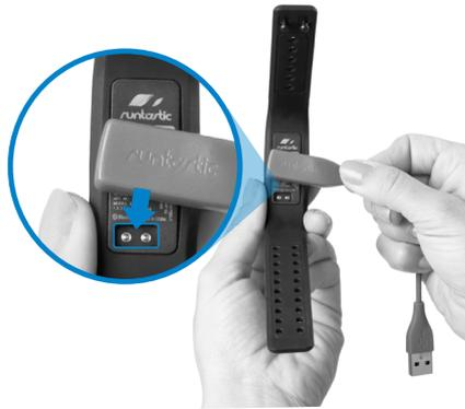
Verbinde den Orbit über das mitgelieferte Ladekabel mit einem USB-Port, um den Akku wieder aufzuladen.
