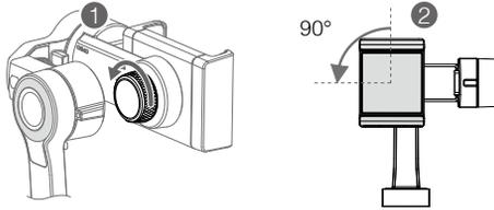
2. Platzieren Sie das Mobiltelefon in der Mobilgerätehalterung, und ziehen Sie die Seiten gleichzeitig nach außen. Lassen Sie die Seiten der Halterung dann los, so dass das Telefon fixiert wird. Halten Sie den Osmo Mobile 2 waagrecht, und stellen Sie die Position des Telefons (im Halter) so ein, dass die Neigungsachse ausbalanciert ist. Die Neigungsachse ist ausbalanciert, wenn das Mobiltelefon still liegt, sobald es losgelassen wird.
