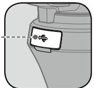
Verbinden Sie den USB-Anschluss über ein Standard-Micro-USB-Kabel mit Ihrem Mobiltelefon. Wenn der Osmo Mobile 2 eingeschaltet ist, wird der Ladevorgang gestartet. Drücken Sie die Ein/Aus/Modus-Taste einmal, während der Osmo Mobile 2 ausgeschaltet ist, um den Ladevorgang zu starten.
