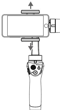
2. Drehen Sie das Mobiltelefon um (so dass es nach unten zeigt), und stellen Sie die Position des Telefons (in der Halterung) so ein, dass die Neigung der Achse ausbalanciert ist. Die Neigungsachse ist ausbalanciert, wenn das Mobiltelefon still liegt, sobald es losgelassen wird.
