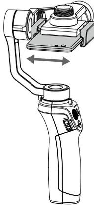
3. Stellen Sie die Rollachse ein, indem Sie die den Balance-Justierknopf lösen und den Justierbügel ausfahren. Die Rollachse ist ausbalanciert, wenn das Mobiltelefon still liegt, sobald es losgelassen wird.
