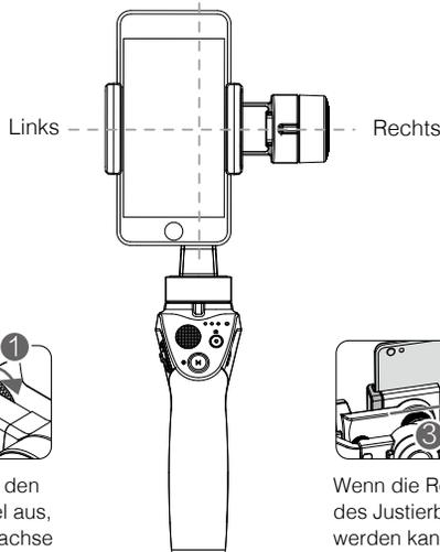
Richten Sie den Justierbügel aus, um die Rollachse auszubalancieren.
