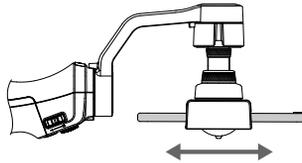
3. Stellen Sie die Rollachse ein, indem Sie entweder den Balance-Justierknopf lösen und den Justierbügel ausfahren oder die Position des Mobilgerätehalters einstellen. Die Rollachse ist ausbalanciert, wenn das Mobiltelefon still liegt, sobald es losgelassen wird.
