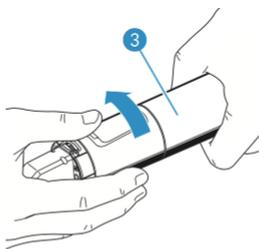
Der Aufstecksender liefert keine Phantomspeisung. Man steckt die XLR m Buchse des Mikrofons auf die XLR f Buchse des Senders. Danach wird die mechanische Verriegelung im Uhrzeigersinn festgeschraubt. Ein Aufstecksender kann man verwenden, wenn man zB. ein Shure Beta SM58 Gesangsmikro als Funkmikrofon benutzen möchte.
