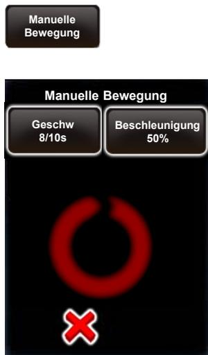
Im Menü für **manuelle Bewegung** können für den Einsatz des Funk-Fernauslöser die **Rotationsgeschwindigkeit** und die **Beschleunigung** individuell bestimmt werden.
