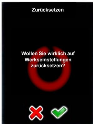
Klicken Sie **„Zurücksetzen“**, um alle Programme zu entfernen und die Werkseinstellungen des VR Drives zu laden.
