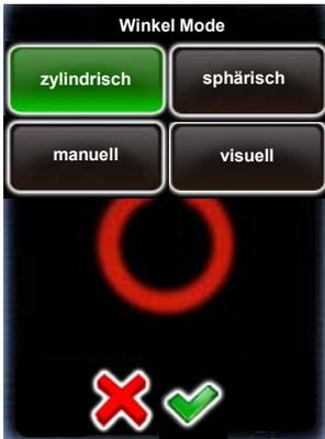
Klicken Sie auf **„Winkel Modus“**, um die Art und Weise, wie die Reihen (Elevation, Anzahl Bilder) berechnet werden zu verändern.
