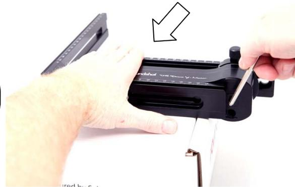
**Schritt 6:** Öffnen Sie jetzt die Schraube in der y-Motor Rotationsachse mit dem kleinen Inbus-Schlüssel (im Gegen-Uhrzeigersinn)
