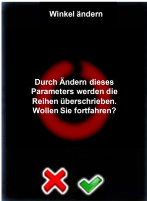
Eine Veränderung des Winkels hat im Winkel-Mode „zylindrisch“ oder „sphärisch“ eine automatische Neuberechnung der Reihen (Elevation/Bilder) zur Folge.
