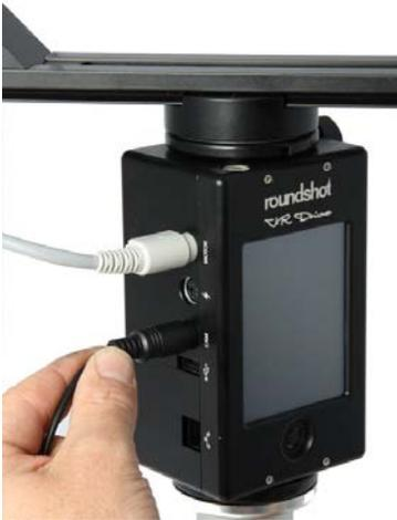
Stecken Sie das Auslösekabel in den VR Drive x-Motor.
