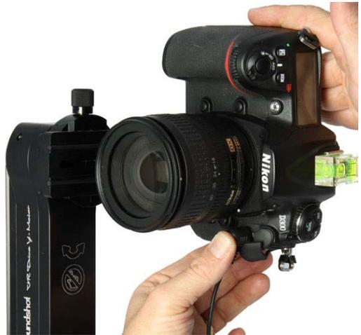
Stecken Sie das andere Ende des Auslösekabels in die Kamera. Drücken Sie den Stecker fest in die Buchse.
