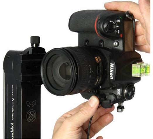
Stecken Sie das **Auslösekabel in den VR Drive x-Motor** und in **die Kamera**. Drücken Sie den Stecker fest in die Buchse.
