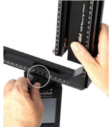
**Schieben Sie den VR Halter mit dem y-Motor in den Schnellverschluss und arretieren Sie ihn.**
