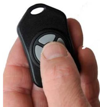
Dann drücken Sie die „**OK**“ Taste des **Funksenders**. Dies synchronisiert das Funksignal zwischen Sender und Empfänger.
