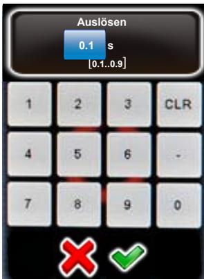
Klicken Sie auf **„Auslösen“**, um die Dauer des Auslösesignals für jede Bildaufnahme zu verändern.
