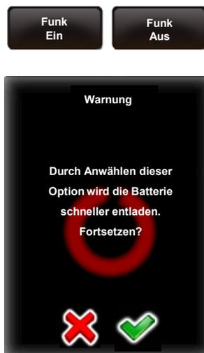
Mit “**Funk ein**” kann das VR Drive aus Distanz eingeschaltet werden. Die Fernsteuerung (links/rechts/auf/ab) ist in beiden Optionen (Funk ein/aus) möglich.
