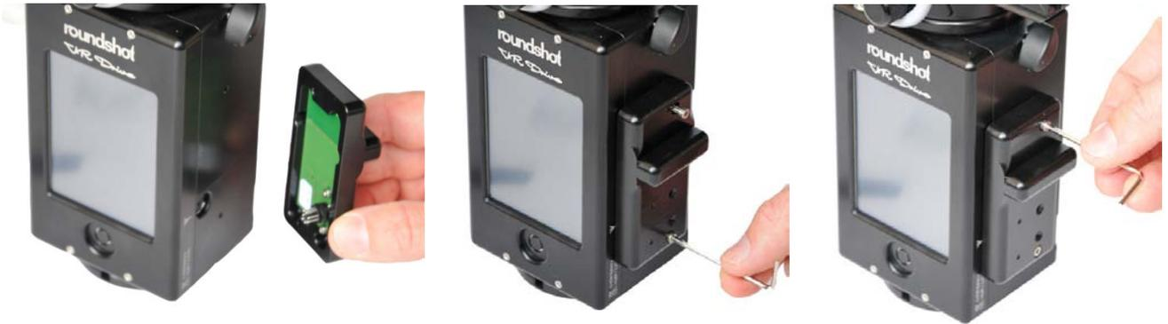
Schieben Sie die **PINS** des **Funkempfängers** in die mit dem Antennen-Symbol bezeichnete Buchse.
