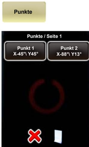
Klicken Sie auf **“Punkte”**, um die Punkte, durch welche der Video-Schwenk geführt wird, zu editieren.
