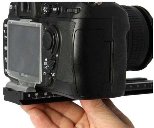
**Stellen Sie sicher, dass die Kamera immer an der gleichen Stelle befestigt wird.** Wir empfehlen, die Kamera ganz nach hinten zu schieben (Nullposition). Falls Sie unterschiedliche Positionen verwenden, stimmen die Nodalpunkte der Software nicht mehr.
