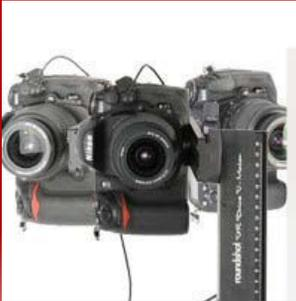
Der VR Drive **Qualitäts-Modus** ist die Basis-Funktion für Panoramas bis zu 360°. Die Kamera wird für jede Position gestoppt und ausgelöst. Dieser Modus eignet sich für Panoramas mit schwierigen Lichtverhältnissen (Innenaufnahmen) oder für Bracketing und HDR-Aufnahmen.
