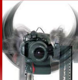
Im **Speed-Modus** wird die Kamera ohne stoppen rotiert und ausgelöst, ideal für Aussenaufnahmen mit bewegten Objekten. In der Regel wird dafür eine Verschlusszeit von 1/500 Sek. oder schneller benötigt (6 Sekunden Rotation / 360°).
