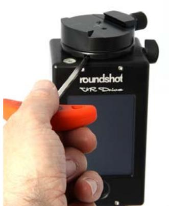
Falls das VR Drive sehr stark am Stativ festgeschraubt ist, lässt es sich mit dem Inbus-Schlüssel **lösen**.
