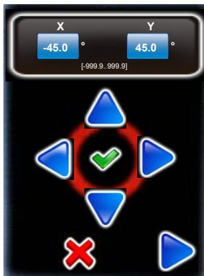
Definieren Sie den nächsten Punkt der Sequenz, indem Sie die Pfeiltasten verwenden oder den Winkel direkt mit den X und Y Feldern eingeben.
