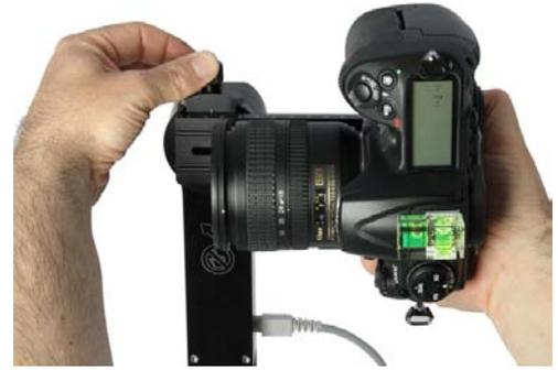
Schieben Sie die Kamera mit der Nodalschiene in die Nodalschienen-Halterung.
