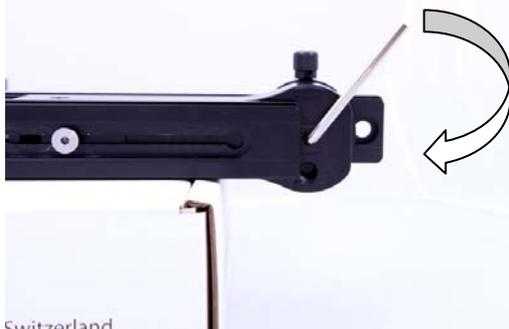
**Schritt 8:** TightenZiehen Sie die Schraube innerhalb des y-Motors mit dem Inbus-Schlüssel wieder an (Uhrzeigersinn)
