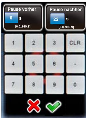
Wenn die Belichtungszeit der Kamera auf 20s eingestellt ist, sollte die **“Pause nachher”** auf **22s** gesetzt werden. 20 Sekunde für die Belichtung und 1 bis 2 Sekunden als Sicherheitsmarge.
