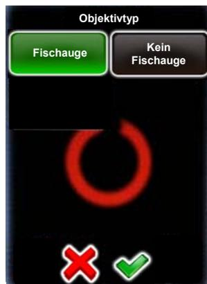
Klicken Sie auf **“Objektivtyp”**, um den Typ des an der Kamera montierten Objektivs zu ändern. Wählen Sie zwischen **“Fischauge”** oder **“Kein Fischauge”**.
