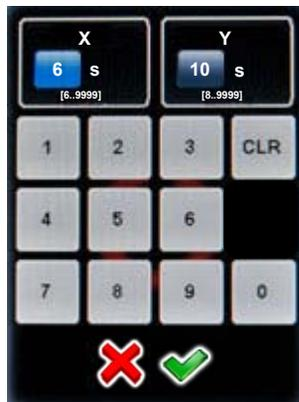
Geben Sie die Fahrgeschwindigkeit des VR Drives in der X und Y Dimension (in Sekunden) ein.
