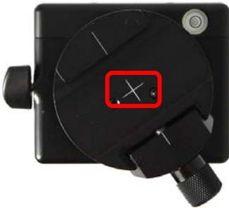
Schauen Sie durch den Kamerasucher, öffnen Sie die Schnellverschluss-Arretierung und verschieben Sie den VR Halter seitwärts, bis sich das Zentrum des Suchers exakt über dem Mittelkreuz des VR Drives befindet (Rotations-Zentrum).
