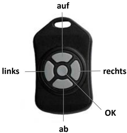
Positionieren Sie das VR Drive mit den **links/rechts/auf/ab** Tasten in der X- und Y-Dimension.
