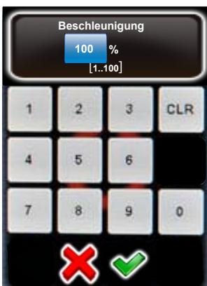
Klicken Sie auf **„Beschleunigung“**, um den Grad der Geschwindigkeitsanpassung beim Start/Stop des VR Drives zu bestimmen.
