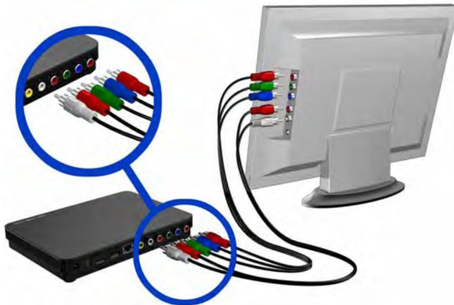
3. Für die Audio-Übertragung stecken Sie die Audiokabelanschlüsse in die Audiobuchsen am Media Center.
