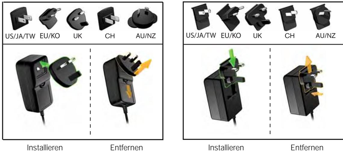
2. Schließen Sie das Stromkabel am Media Center an und stecken Sie das andere Ende in die Steckdose. Das Media Center schaltet sich automatisch ein.
